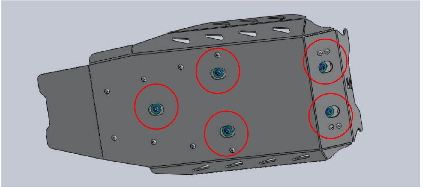
APPLICARE IL PARAMOTORE CON LE RONDELLE M6 DIN9021 E LE VITI M6X16 ISO7380
