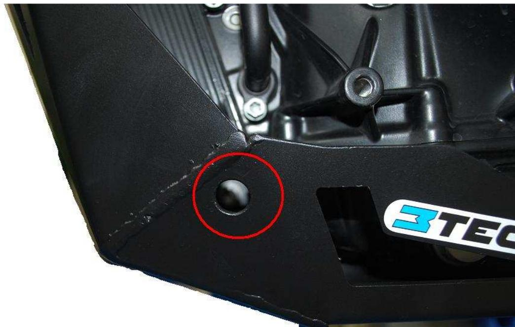
Figura 5: foro per l'accesso alla vite M8X110
