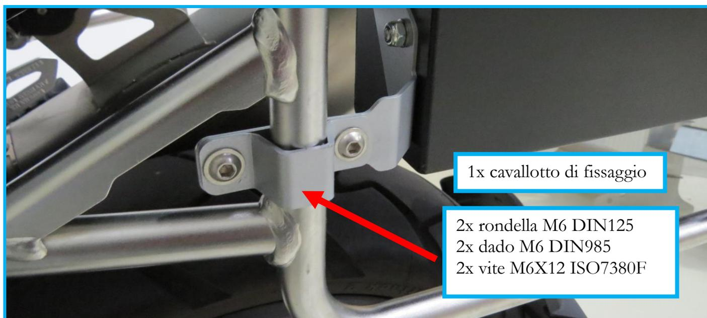
**Controllare il fissaggio delle viti dopo circa 30 chilometri.**
