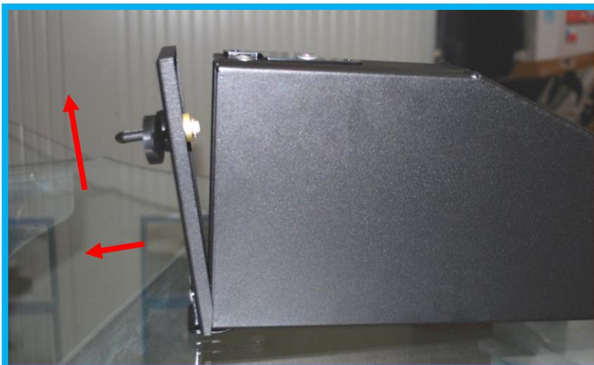
Inserire la chiave nel blocchetto della serratura e ruotare in senso antiorario. Tirare il coperchio verso l'esterno e sollevarlo verso l'alto facendolo uscire dalla sede.
