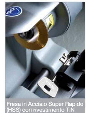
Fresa in Acciaio Super Rapido (HSS) con rivestimento TiN
