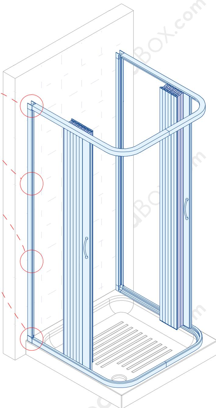
**13** Eseguire la stessa operazione di cui al punto 12 anche per il **profilo attacco destro**. Porsi **all'interno del vano doccia** ed inserire ad incastro il **profilo attacco anta** nel **profilo laterale destro**. Iniziando dalla parte superiore, esercitare la pressione necessaria a sentire lo scatto d'inserimento, procedere quindi per l'intera lunghezza del profilo laterale.
