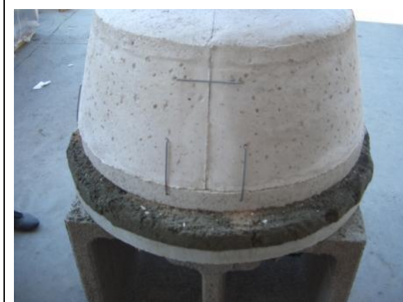
Posizionamento della lana di roccia spessore 10 cm. densità 100 su rete metallica.
