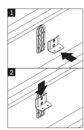
INSTALLING SLAT SUPPORTS AT THE SAME LEVEL
