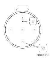
電源ボタンを押して Beosound Explore を起動します。 電源ボタンを 5 秒間長押しする と電源が切れます。
