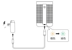
本製品の充電には、付属の専用充電ケーブルをお使いください。 付属のケーブルを「カチッ」と音がするまで奥に入れて充電してください。 充電中は、本体のインジケーターが橙色に点滅し、充電完了時に緑色に点灯します。
