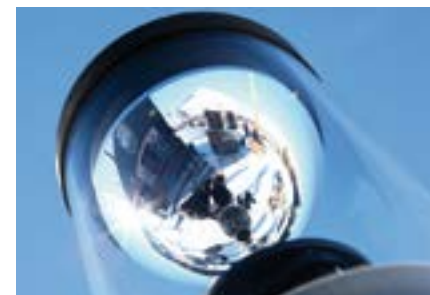
360-Grad-Kamera: umhüllendes DURAN® Rohr als Schutz vor Kratzern, Umwelteinwirkungen und Spiegelungen
