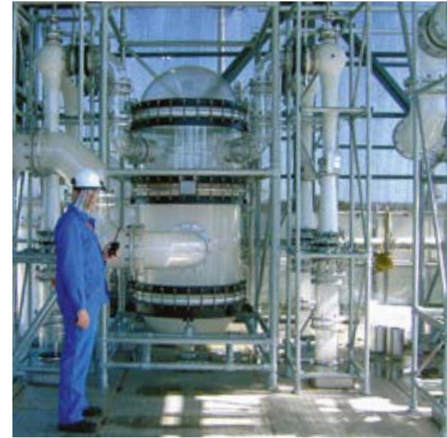
Chemischer Apparatebau: geometrisch präzises DURAN® Rohr für großtechnische Anlagen
