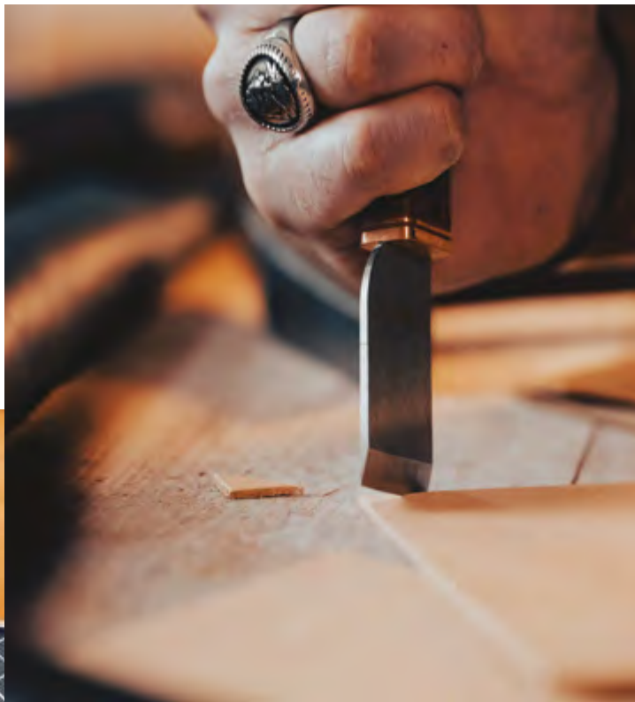
À l'aide d'un couteau à parer droit ou cutter : commencer la coupe en quartiers.
