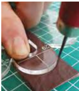
À l'aide d'un gabarit et d'une alêne ronde : tracer l'arrondi.
