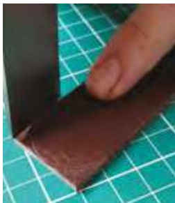
À l'aide d'un couteau à parer droit ou cutter : commencer la coupe en quartiers.
