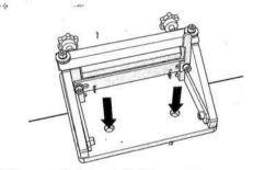
Secure machine to bench with bolts or screws. 使用螺栓/螺絲將機器固定在工作台上。
