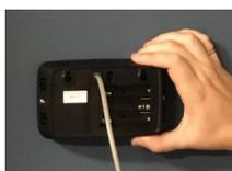
D. Zorg voor een gat met een diameter van 19 mm in de wand of de rackstructuur om ruimte te bieden voor de routing van de RJ-9-verbinding aan de achterkant van de controller.
