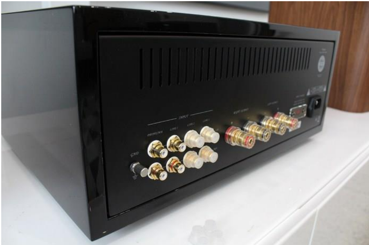
La connectique de l'ampli Supravox Vouvray est uniquement analogique.
