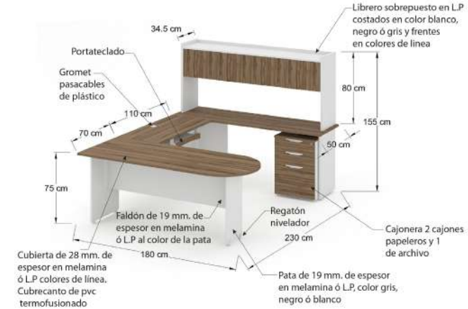
Especificación gráfica de cubierta línea Qualium (LPAQEJE1)
