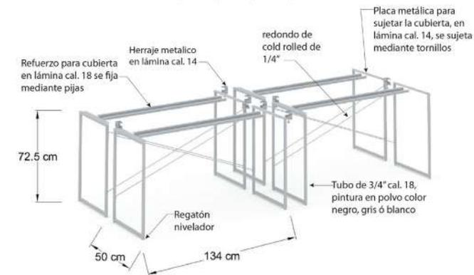
Cubierta de 15 mm. de espesor con esquinas rectas o redondeadas en melamina ó L.P colores de línea. Cubrecanto de pvc 2 mm.
