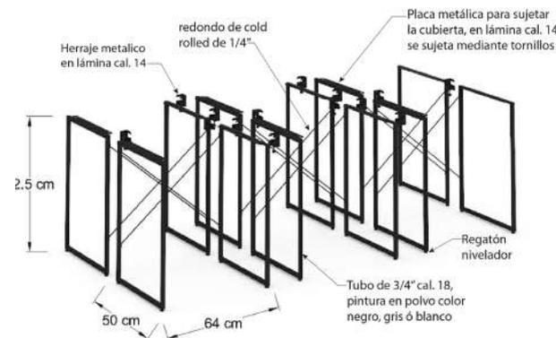
Cubierta de 15 mm. de espesor con esquinas rectas o redondeadas en melamina ó L.P colores de línea. Cubrecanto de pvc 2 mm.
