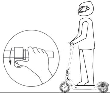
3. Lorsque le scooter commence à rouler en roue libre, posez les deux pieds sur le plancher et appuyez sur l'accélérateur (l'accélérateur se déclenche lorsque la vitesse en roue libre dépasse 3 mph).
