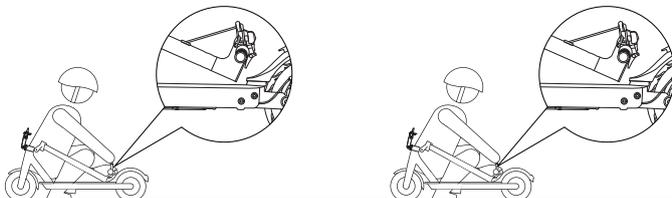
Assurez-vous que le scooter est éteint. Pour plier, déverrouillez le mécanisme de pliage, et pliez la tige du guidon pour accrocher la boucle sur le garde-boue arrière. Pour ouvrir, appuyez sur la gâchette de la cloche pour la retirer de la boucle, redressez le guidon et verrouillez la structure de pliage.
