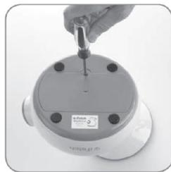
Utilisez un tournevis cruciforme standard pour accéder à la cavité de la batterie.
