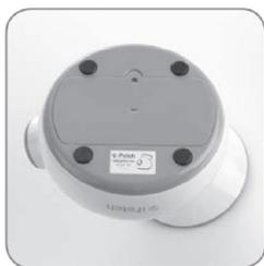
Votre iFetch a un compartiment à piles sur le côté inférieur de l'appareil. L' iFetch prend 6 piles C Cell.
