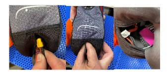
4. Im zweiten Schritt den rechten Akku einschieben und den Stecker in die rechte Buchse einstecken. Die Kabel auf die rechte Seite legen, wie bereits oben beschrieben
