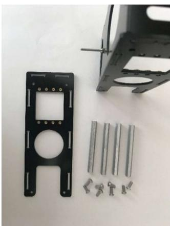
4 M4 75mm Aluminium Abstandshalter mit M4 10mm Schrauben auf Seitenplatte schrauben.
