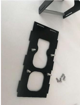
Seitenplatte auf den Rücken legen und Front- und Rückenplatte aufsetzen. Die im Bild gezeigten 4 Stehbolzen kommen von einem alten Designstand und werden nicht benötigt.
