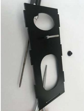
Rückenplatte mit M3 30mm Schraube und selbstsichernder Mutter verschrauben. Alle Schrauben sehr gut festziehen. Dies ist wichtig, da sich sonst nachher die Rändelmutter nicht richtig festziehen und lösen lässt.
