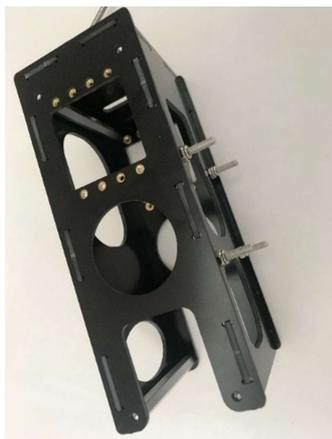
Andere Seitenplatte aufsetzen und verschrauben.
