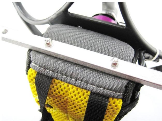
Auf der Oberseite des Metallsitzes sind zwei Bohrungen durch welche zwei M3x16mm Senkkopfschrauben von innen nach außen gesteckt werden. Der Alübügel ist an diesen Schrauben zu befestigen. Halten Sie mit einem langen Inbusschraubendreher die freie Schraube von innen, stecken Sie den Alübügel auf die Schraube und sichern Sie den Bügel mit einer M3 Unterlegscheibe und einer M3 Stopmutter.
