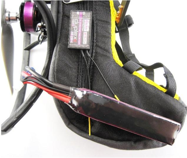
Für den empfohlenen Antrieb benötigen Sie einen 3S LiPo-Akku mit einer Kapazität von bis zu 5000 mAh.
