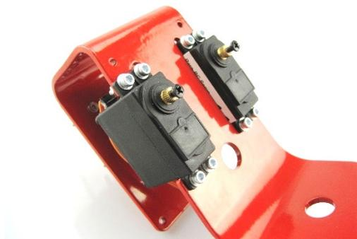
Montieren Sie nun die beiden Servos mit M3x12mm Schrauben, Beilagscheiben und Muttern wie auf dem Bild zu sehen.
