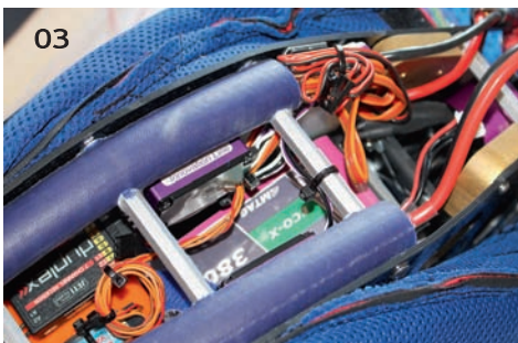
01 | Start mit dem Rucksackmotor „Noah Free“ 02 | Markierung und Einstellung der Bremsleinen 03 | Hacker-Motor, DiteX-Servos, 3s-LiPo mit 3.800 mAh, Empfänger und SM Vario im Liegegurtzeug „Rocket“ mit dem Spezialpropeller 14 x 8 Zoll 04 | Das „Noah Free“-Set besteht aus einem gefrästen GFK-Körper
