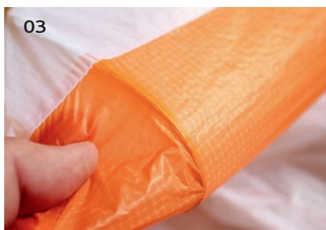
01 | Der Aufbau einer „Rast“ Zelle am Modell 02 | Ein Blick in das Innere einer „Rast“ Zelle im RC-Gleitschirm 03 | Die eingenähten Nitinol-Stäbchen in den Rippentaschen gewährleisten eine dauerhafte Profiltreue 04 | Start mit einem Liegegurtzeug „Rocket“
