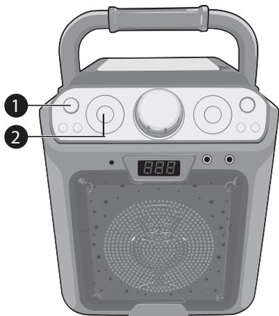
**1** Conecte la unidad como se describió antes. Oprima el botón de **ENCENDIDO/APAGADO (ON/OFF)** para encender la unidad.
