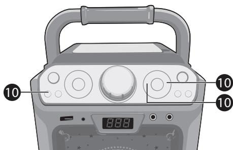
**10 SUIVANT:** Avancez ou reculez d'une piste en appuyant sur les boutons **SUIVANT -/Navigation** et **SUIVANT +/Navigation**. Vous pouvez également avancer de 10 pistes/fichiers en appuyant sur le bouton **10+**.
