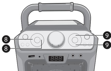
9 Ajustez la clé en utilisant les boutons **CLÉ +/▲** et **CLÉ -/▼** pour obtenir la meilleure clé pour le chanteur.
