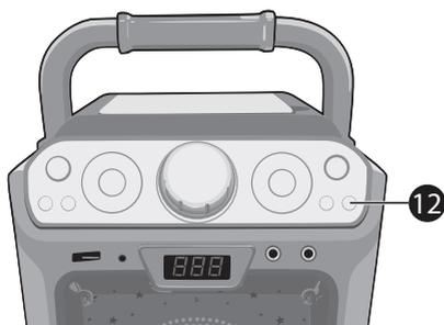
**12 PROGRAM:** Vous pouvez programmer jusqu'à 20 pistes de n'importe quel disque pour les lire dans l'ordre que vous souhaitez. Lorsque l'appareil est en mode Stop, appuyez sur le bouton **RÉPÉTER/PROGRAMMER** ; le voyant de programme se met à clignoter et "01" apparaît à l'écran, indiquant que vous pouvez programmer le premier titre
