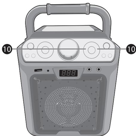
**10** **SUIVANT:** Avancez ou reculez d'une piste en appuyant sur les boutons **SUIVANT -/Navigation** et **SUIVANT +/Navigation**.
