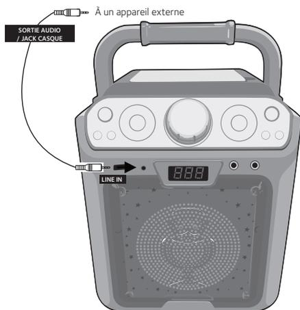
Connectez un appareil externe en utilisant un câble adapté (câble audio 3.5 mm non inclus) tel que c'est indiqué.
