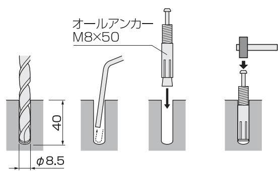
穴を開ける ▶ 切粉を除去する ▶ アンカーをセットする ▶ ハンマーでピンを打ち込む
