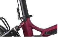
Entriegeln Sie schließlich die Rahmenverriegelung und klappen Sie die beiden Rahmenteile übereinander:
