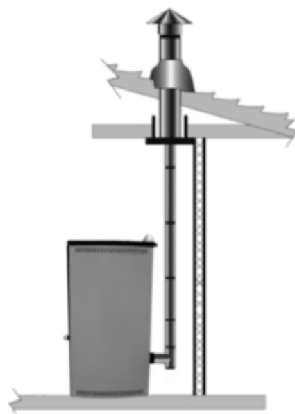
Figure 4: Schéma de connexion directe
