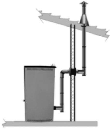
Figure 5: Schéma de raccordement avec 2 courbes
