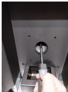
Fig. 55 - Nettoyage avec nettoie-pipes
