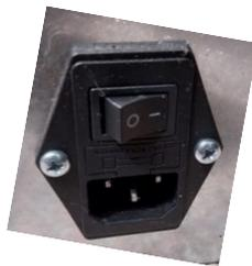
Fig. 39 - Prise électrique avec interrupteur général
