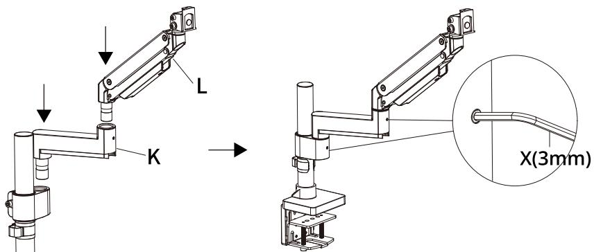
\*注意: 拆除手臂時，連接件套筒中的小螺絲(Spres-1)可能掉落，重新安裝手臂前請務必將掉落的小螺絲裝回螺絲孔。
