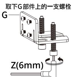
使用 6mm 板手將螺栓穿過部件 GH 及收線孔，並施力鎖入底座中。
