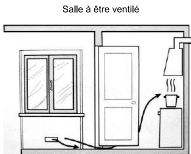
Agrandissement de la fente de ventilation entre la fenêtre et le plancher
