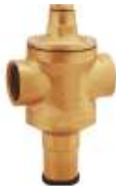
Fig. 12 - Un réducteur de pression est nécessaire si la pression d'eau de votre maison est supérieure à 80 psi (552 kPa).
