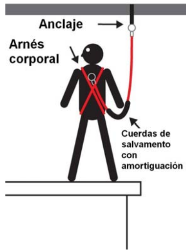
Fig. 3.2 Conexión típica de detención de caídas
