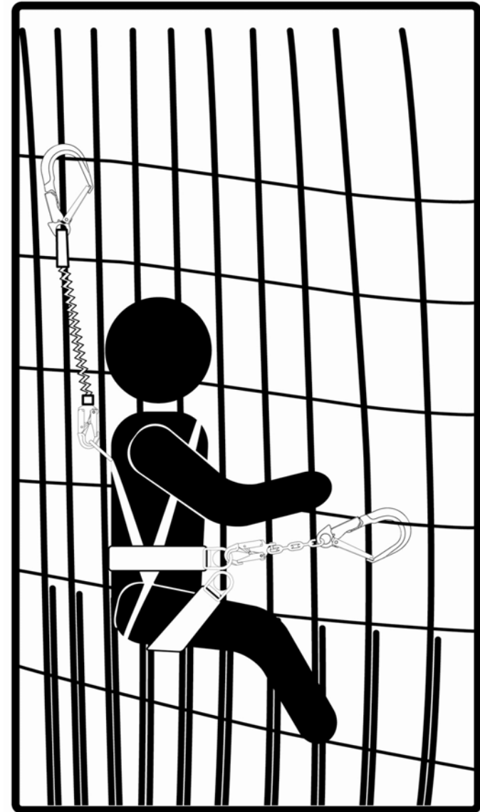
Fig. 3.3 Posicionamiento del trabajo típico
