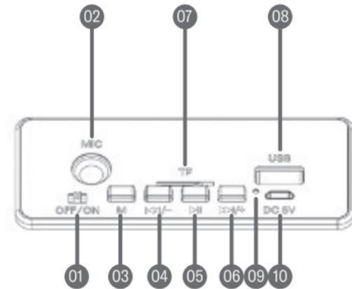
1. INTERRUPTOR DE ENCENDIDO / APAGADO
