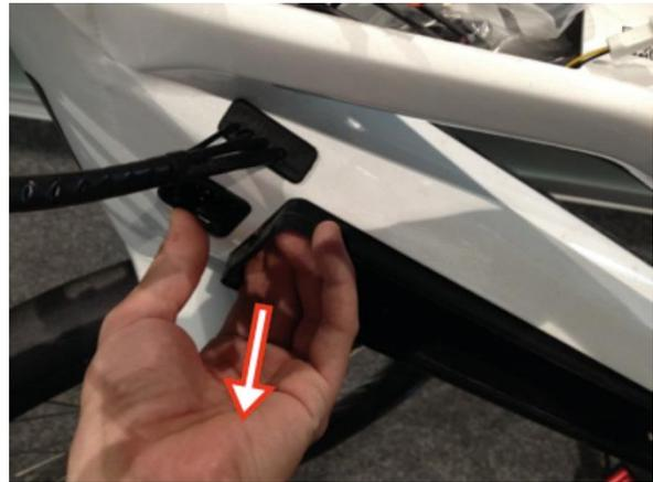
b. Kommunikation zum Verteiler (4-polig)
