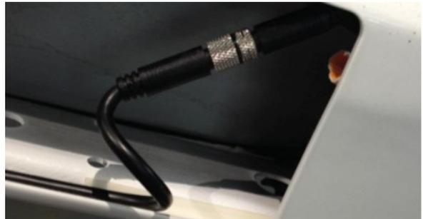
8. 3-Phasen-Kabel vom Motor-Controller [ abziehen
