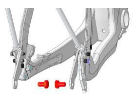
M10 x 1 Vollachskupplungen werden von diversen Hersteller für die Montage an Nabenschaltungen wie Rohloff oder SRAM iMotion/Dual Drive angeboten.
