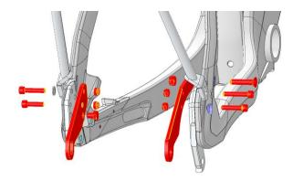
Für die Montage von Vollachskupplungen wie zum Beispiel BobYak und FollowMe werden sowohl die linke als auch die rechte Anhängerplatte benötigt. Die M10 x 1 Vollachskupplungen können an den im Trailer Plate SP Kit ST2 mitgelieferten M10 Schrauben befestigt werden.
