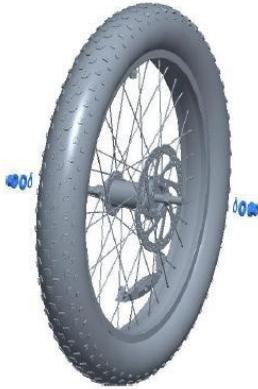
(2) Coloque la rueda delantera en la ranura de la horquilla delantera y asegúrela apretándola con una llave de 15 mm.
