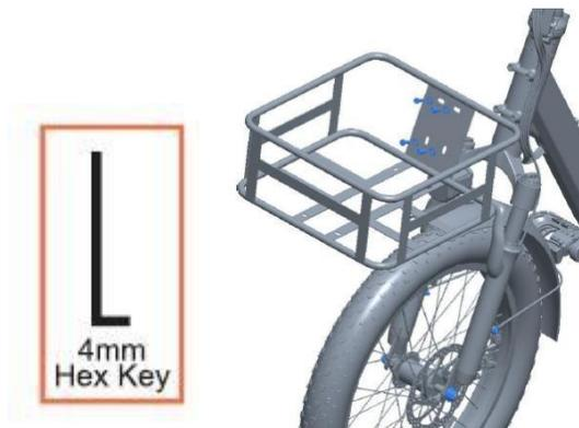
(2) Asegure el estante instalando los 4 pernos en el sentido de las agujas del reloj con una llave hexagonal de 4 mm.
