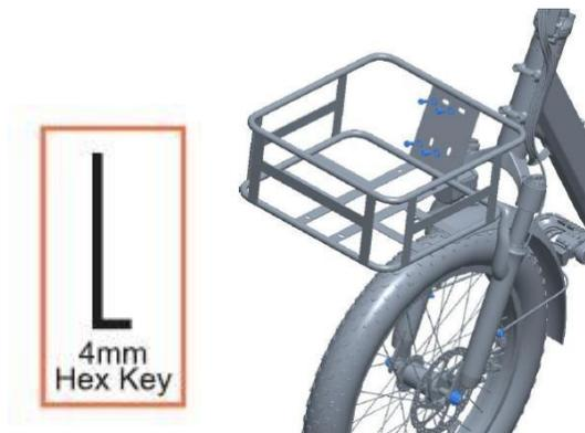
(2) Fissare il ripiano installando in senso orario i 4 bulloni utilizzando una chiave esagonale da 4 mm.
