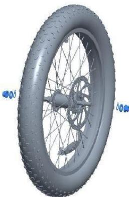
(2) Posizionare la ruota anteriore nella fessura sulla forcella anteriore e fissarla serrando con una chiave da 15 mm.
