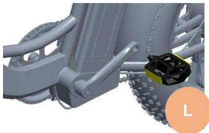
(2) Stringere il pedale destro in senso orario e il pedale sinistro in senso antiorario utilizzando una chiave da 15 mm.
