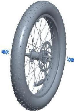
(2) Setzen Sie das Vorderrad in den Schlitz an der Vordergabel ein und befestigen Sie es, indem Sie es mit einem 15-mm-Schraubenschlüssel festziehen.
