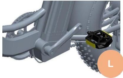
(2) Ziehen Sie das rechte Pedal mit einem 15-mm-Schraubenschlüssel im Uhrzeigersinn und das linke Pedal gegen den Uhrzeigersinn fest.
