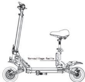
2. Pressez l'axe du siège à côté.
