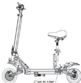
3. Lorsque l'axe est pressé au bout, couchez lentement le siège en tenant le support avec la main.
