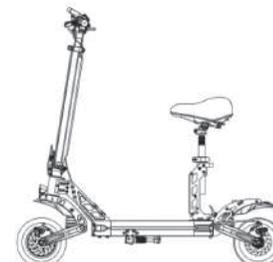
3. Agite el soporte del asiento para confirmar que el eje del asiento está atascado en la ranura para tarjetas.
