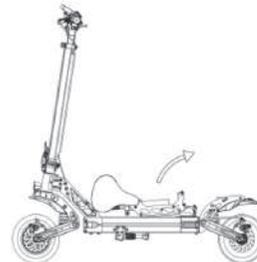
2. Cuando el soporte del asiento esté completamente erigido, suelte el eje del asiento para que el eje del asiento encaje en la ranura para tarjetas.
