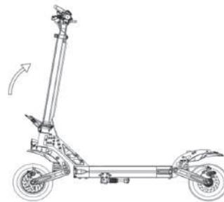
4. Ajuste la palanca del cuerpo y coloque el gancho en la ranura del gancho.
