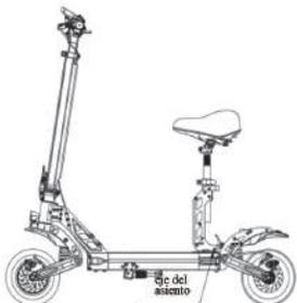
3. Después de presionar el eje del asiento hacia la parte inferior, sostenga el soporte del asiento con una mano y baje lentamente el asiento.
