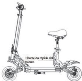
2. Después de dejar la liberación rápida del asiento, presione hacia abajo en el eje lateral del asiento.
