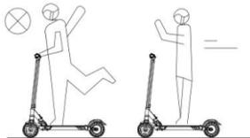
6.No intente pasar directamente por encima de escalones con una separación de más de 3 cm, ya que puede provocar el vuelco del scooter y causar lesiones al conductor o daños al producto. También trate de evitar los escalones de menos de 3 cm.
