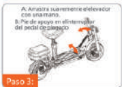
Paso 3: A: Arrastra suavemente el elevador con una mano B: Pie de apoyo en el interruptor del pedal de plegado
