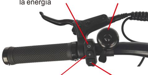
"+" es el botón de cambio de velocidad; mantén pulsado para encender la luz delantera
