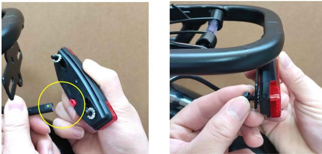
13. Instale la luz trasera: primero conecte el cable de control de la luz trasera a la luz trasera y luego fije la luz trasera a la percha trasera con tornillos.
