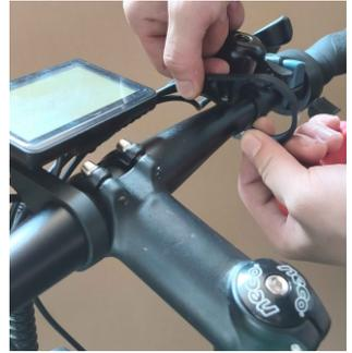
1. La pantalla se puede instalar solo después de instalar el manillar. Para facilitar la instalación, como se muestra en la imagen de arriba a la izquierda, una de las abrazaderas de tubería del instrumento se puede quitar completamente primero.
