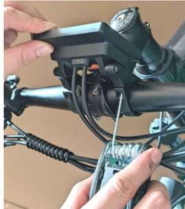
4. Afloje el clip de fijación de la unidad del botón, haga clic en el tubo del manillar y luego apriete el tornillo de fijación, como se muestra en la figura a continuación.
