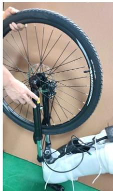
4.Coloque la rueda delantera en la horquilla delantera para la instalación, preste atención a que la pastilla del freno de disco y el freno de disco coincidan en su lugar.
