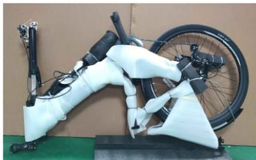
2. Dé la vuelta a la bicicleta como se muestra arriba para facilitar la instalación de las ruedas delanteras.
