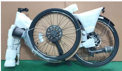
1.El estado de la bicicleta después de sacarla de la caja es el que se muestra en la figura anterior. Primero, corte todas las correas de nailon para asegurarse de que la rueda delantera se pueda separar suavemente del marco cuando la rueda trasera pueda girar libremente.
