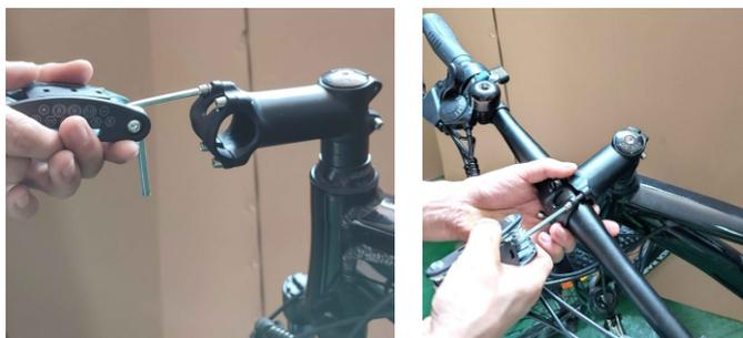
8. Afloje los 4 tornillos del vástago del manillar, coloque el manillar y ajuste el ángulo horizontal del manillar, y luego fíjelo con los tornillos de la abrazadera del tubo.
