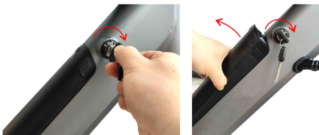
Extracción de la batería: inserte la llave, gírela hacia la derecha con la mano derecha y extraiga la batería con la mano izquierda. Después de quitar la batería, se puede cargar solo con el cargador.
