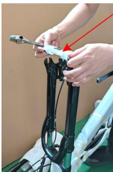
3. Afloje los tornillos de fijación de la barra de protección de la horquilla delantera con una llave ajustable y retire la barra de protección de la horquilla delantera.
