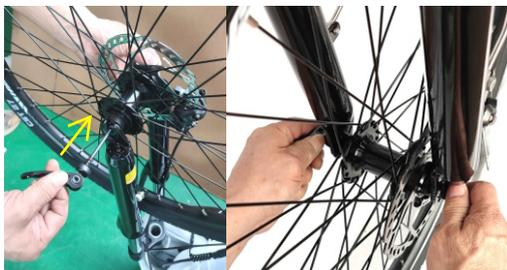
6.Inserte el tornillo de liberación rápida del eje delantero en el núcleo del eje delantero, apriételo con la tuerca y luego presione la manija de liberación rápida para bloquear la horquilla delantera.
