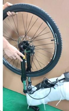
4. Setzen Sie das vorderrad zur montage auf die Vorderradgabel, achten Sie darauf, dass der Scheibenbremsbelag und die Scheibenbremse zusammenpassen.
