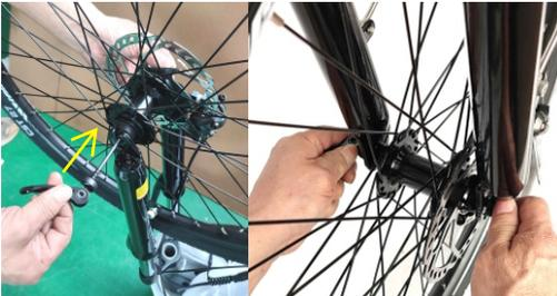
6. Setzen Sie die Schnellspannschraube der Vorderachse in den Vorderachskern ein, ziehen Sie sie mit der Mutter fest und drücken Sie dann auf den Schnellspanngriff, um die Vorderradgabel zu verriegeln.
