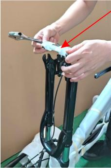
3. Lösen Sie die Befestigungsschrauben der Vorderradgabel-Schutzstange mit einem verstellbaren Schraubenschlüssel und entfernen Sie die Vorderradgabel-Schutzstange.
