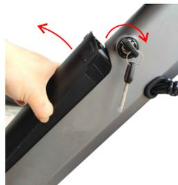
Akku entnehmen: Schlüssel einstecken, mit der rechten Hand nach rechts drehen und mit der linken Hand den Akku herausziehen. Nachdem der Akku entfernt wurde, kann er alleine mit dem Ladegerät geladen werden.
