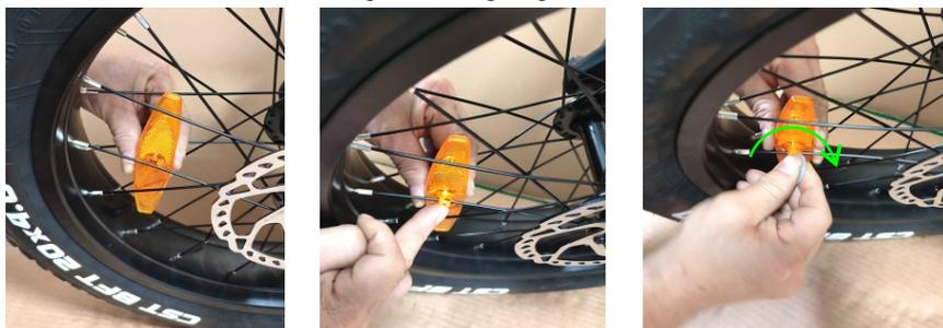
11. Setzen Sie den Radreflektor auf die Speiche, drücken Sie den Clip in das Loch und drehen Sie den Clip mit einem Werkzeug, um ihn zu verriegeln.
