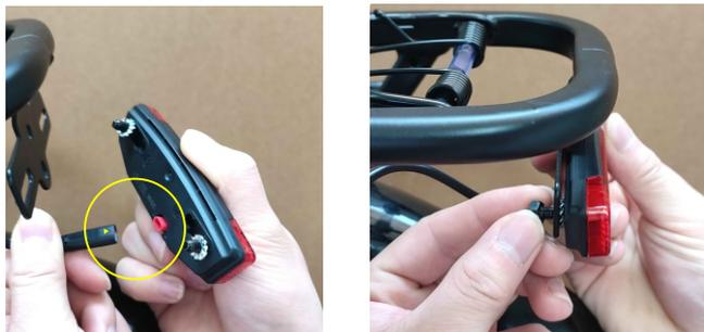
13. Installieren Sie das Rücklicht: Verbinden Sie zuerst das Steuerkabel des Rücklichts mit dem Rücklicht und befestigen Sie dann das Rücklicht mit Schrauben am hinteren Aufhänger.
