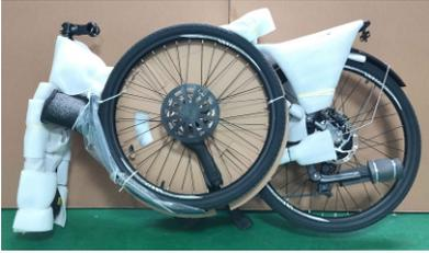
1. Der Zustand des Fahrrads, nachdem es aus dem Karton genommen wurde, ist wie in der obigen Abbildung dargestellt. Schneiden Sie zuerst alle Nylonbänder durch, um sicherzustellen, dass das Vorderrad reibungslos vom Rahmen getrennt werden kann, wenn sich das Hinterrad frei drehen kann.
