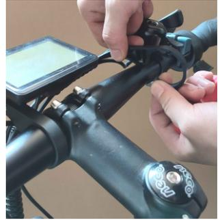
1. Das Display kann erst installiert werden, nachdem der Lenker installiert wurde. Zur bequemeren Installation kann, wie im linken Bild oben gezeigt, zunächst eine der Rohrschellen des Instruments vollständig entfernt werden.
