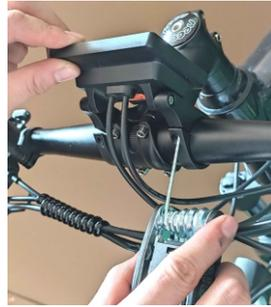
4. Lösen Sie die Befestigungsklammer der Tasteneinheit, klicken Sie sie in das Lenkerrohr und ziehen Sie dann die Befestigungsschraube fest, wie in der Abbildung unten gezeigt.
