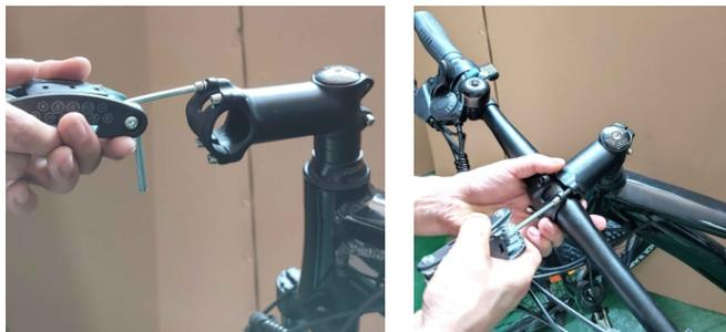
8. Lösen Sie die 4 Schrauben des Lenkervorbau, platzieren Sie den Lenker und stellen Sie den horizontalen Winkel des Lenkers ein und befestigen Sie ihn dann mit den Rohrschellenschrauben.
