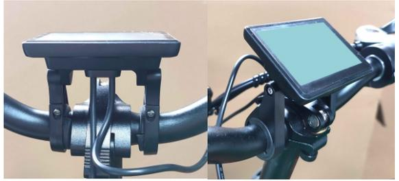
5. Schließen Sie das Kabel des Displays an, wie in der Abbildung oben gezeigt; Achten Sie auf die Pfeilmarkierungen der beiden Stecker..
