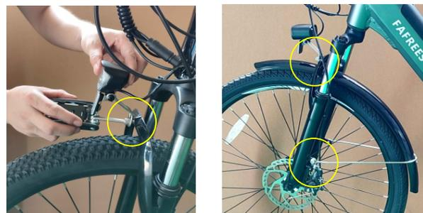
10. Lösen Sie die Scheinwerfer-Befestigungsschraube an der Vorderradgabel, befestigen Sie den Befestigungshaken des vorderen Schmutzblechs und die Scheinwerferhalterung zusammen mit der Schraube an der Vorderradgabel und befestigen Sie dann mit der Schraube die vordere Schmutzblechstütze an der Vorderradgabel, wie in gezeigt das rechte Bild oben.
