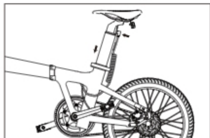
1. Insérez la batterie dans le tube de selle et connectez le câble de la batterie.
