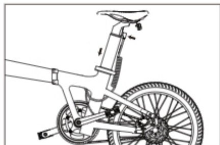
1.1. Setzen Sie die Batterie in das Sitz-Rohr ein und schließen Sie das Batteriekabel an.
