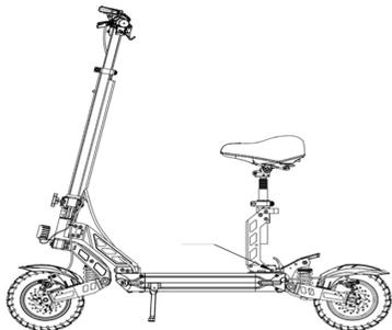
3.Dopo aver abbassato completamente l'ast del sedile, tenere la staffa del sedile con una mano e abbassare lentamente il sedile.
