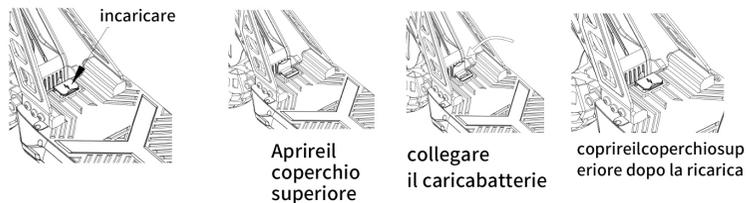
1. Aprire il coperchio superiore della porta di ricarica e inserire la spina del caricabatterie nel foro di ricarica sul corpo.
