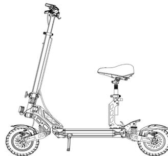
2. Quando la staffa del sedile è completamente eretta, rilasciare l'albero del sedile in modo che l'albero del sedile sia bloccato nella fessura.
