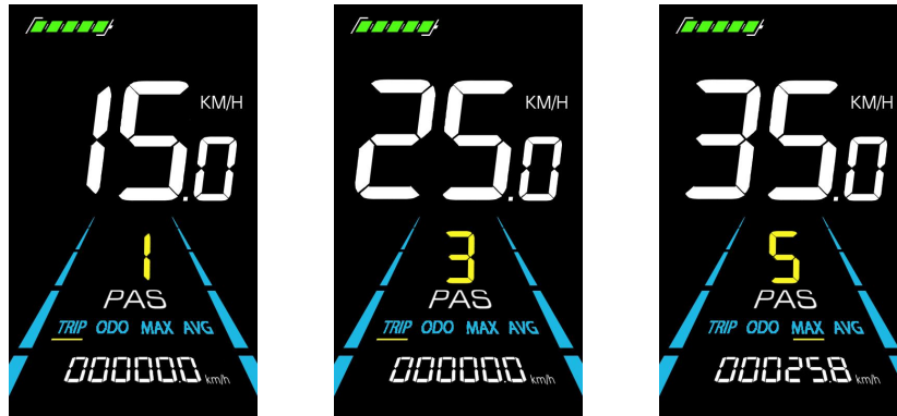
Figure 5-4 PAS level display interface
