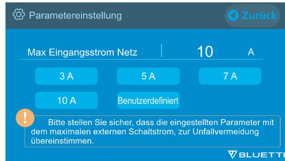
**Hinweis:** Der Netzstrom ist auf 10 A voreingestellt. Die Änderung wird erst dann wirksam, wenn die AC300 an das Netz angeschlossen wird.
