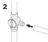
**Étape 2.** Connectez un tuyau de 1,27 cm sur la vanne de dérivation. Connectez l'autre extrémité du tuyau à une pièce d'eau.
