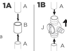
**Paso 2.** Conecte un tubo de 1,27 cm a la válvula desviadora. Conecte el otro extremo del tubo a una fuente de agua.
