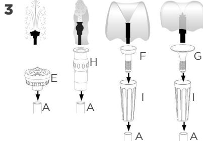
**Paso 4.** Conecte el tubo de extensión a la salida de la bomba utilizando los adaptadores suministrados.
