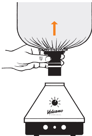
Retirer le Ballon à Valve avec la Chambre de Remplissage
