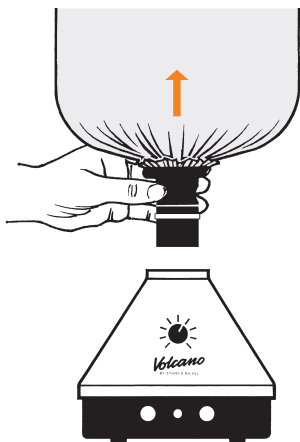
De Ventielballon met Vulkamer verwijderen
