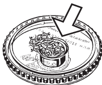
Dosierkapsel beim Befüllen mit Magazindeckel (Trichter)
